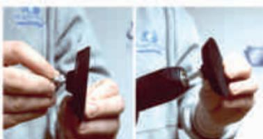
**Important!** Ce kit est conçu pour fonctionner avec une perceuse filaire électrique standard qui fonctionne à la vitesse recommandée de 1 000 tr/min. Ce kit fonctionne avec une meuleuse sans fil, mais le polissage pourra être plus long car la puissance et la vitesse différent.
