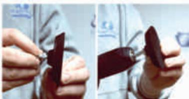
**Importante!** Este kit está diseñado para trabajar con una taladradora eléctrica común de cable, a una velocidad de 1000 rpm. El kit también funciona con taladradoras inalámbricas, pero puede que tarde más en pulir a causa de las diferencias de velocidad y potencia.
